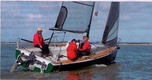
Dès que le bateau prend de la gîte, le safran sous le vent est très efficace en position verticale dans l'axe de la carène immergée alors que le safran au vent est pratiquement hors de l'eau.
