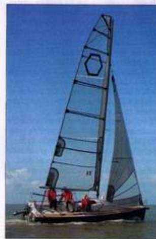
Le Bee 6.50 dispose d'un véritable mât aile en carbone monté sur rotule.
