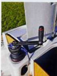
L'unique winch sert principalement pour relever la quille et pour étarquer la grand-voile.
